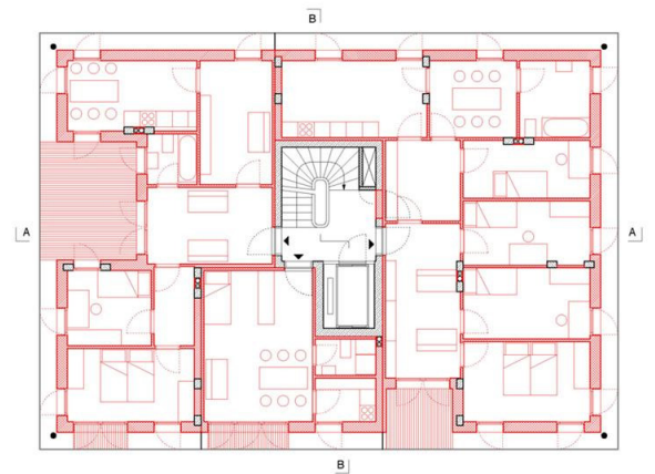
1. irudia ~ Open Building-aren oinarriak. Banda hauen bitartez erabilera ezberdineko espazioak kokatzeko eremu bat definitzen duen azpiegitura ezartzen da. Egilea ~ SAR (Stichting Architecten Research).
