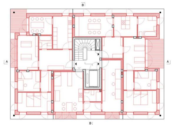
2. irudia ~ Grundbau und Siedler. Beltzez arkitektoek diseinaturiko euskarria. Gorriz, erabiltzaileek diseinatu eta eraikitako etxebizitzak. Egilea ~ Bernhardt und Leeser, Sozietät für Architektur. office@bel.cx
